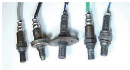
空燃比の値は、空燃比センサーにより空燃比信号としてECUに送られています。ちなみに、空燃比センサーというのは総称です。点検整備の現場では、λ（ラムダ）センサー、A/Fセンサー、LAFセンサー、O<sub>2</sub>センサーなど、異なる名称も多く使われています。
