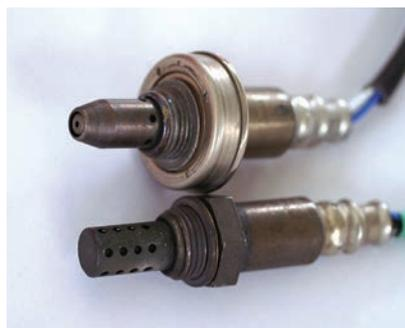
第1図 空燃比センサーとしては、A/Fセンサーの大先輩にあたるO<sub>2</sub>センサー
