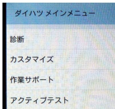
第1図 故障診断、データ表示、アクティブテスト、作業サポートの4種類がSTに共通する基本機能である。なお写真のGSTは、「診断」の中にデータ表示が組み込まれている。また「カスタマイズ」は、車両のカスタマイズ機能を操作する機能
