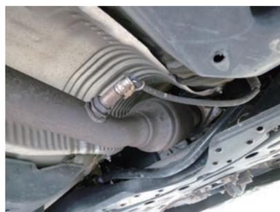
第5図 A/Fセンサーが主役になった現在だが、O<sub>2</sub>センサーも健在である。三元触媒の後方に移動したが、その役目は軽くない。車両は、いつものトヨタ・プリウス（W20系）
