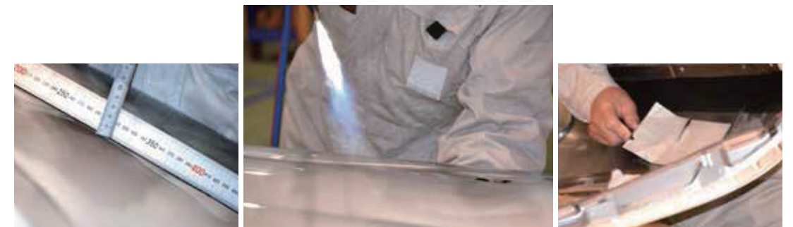
②フェンダーの線傷を修理します
