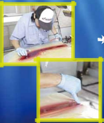
5. 反対側も同様にキャンディーレッドを吹き付け、塗料が生乾きの時に指先で模様を付ける
