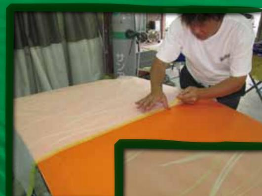
5. 転写用シートの端をセンターで合わせ、テープで固定し、覆い被せる。その際、フレームスを区別するため、先端に印を入れておく
