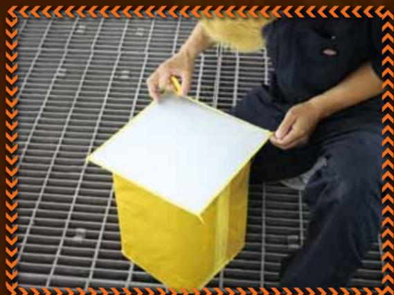
1. フレークとクリアーを塗装し、サンディングしたプレートを用意。中心のライン取りをして、緑をマスキング
