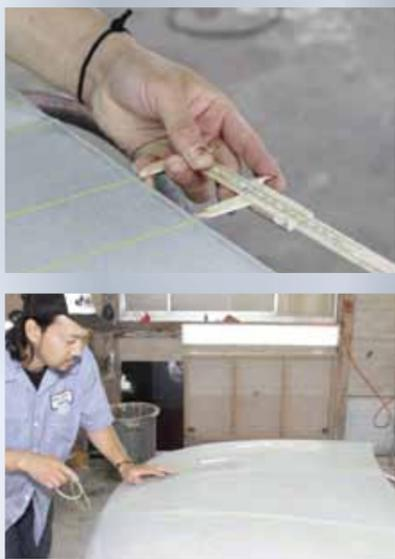
ラインテープは幅 3mm、米国 3M 製を使用した。パネル中心部にラインテープをまっすぐ貼り付け、ノギスを利用してパネル中心からみて、テープの貼った場所が対称になるようにする。
