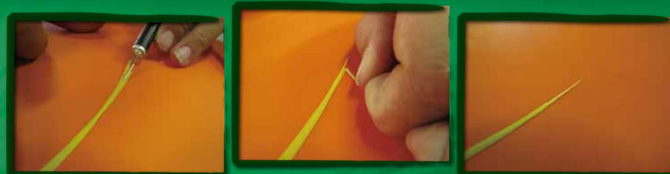
3. 重なり合ったラインテープの先端は、カッターで先を尖らせるように切り取る
