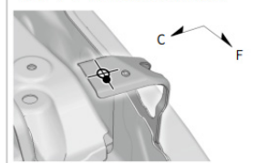
B7, b7 フロントウインドシールドロア 基準穴φ12
