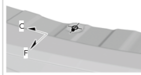
B7, b7 フロント ウィンドシールド ロア 基準穴φ12
