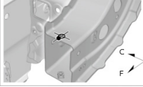
B2, b2 フロントバンパーステム取付け穴φ9
