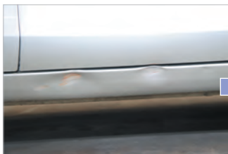
凹みが2カ所。 車両前方が横約7cm、深さ約1cm、 後方が横約10cm、深さ約1cm
