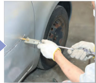
プレートの穴にスライドハンマーを引っ掛け、軽く引き出す
