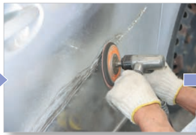
最後に残ったハンダを P60 のペーパーを付けたディスクサンダーで研磨して仕上げる
