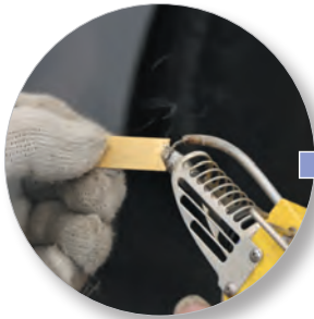
1つ穴のプレートを用意し、先にプレートにもハンダを付ける
