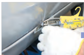
損傷箇所に薄くハンダを付ける
