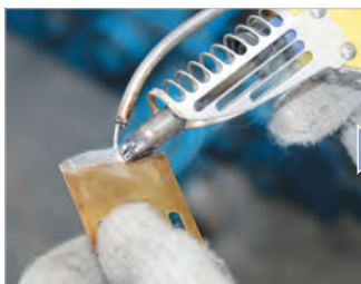
損傷箇所に薄くハンダを付ける
