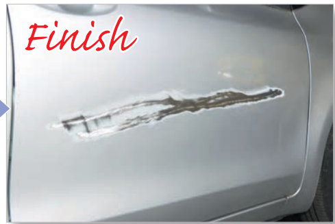
最後に残ったハンダを P60 のペーパーを付けたディスクサンダーで研磨して仕上げる
