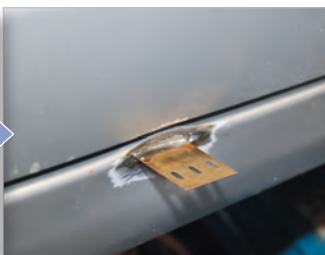
プレートの先端にハンダを付け、凹 みの中心にプレートを取り付ける
