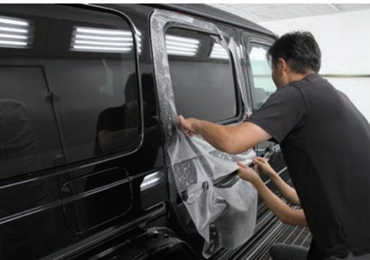
プレカットフィルムの施工。パネルの形にカットされたものを貼り付ける
