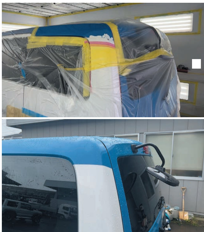
2トーンルーフ塗装時のマスキングは、仕上がりでカラーの境目が明確になるため見切りテープをていねいに貼る必要がある
