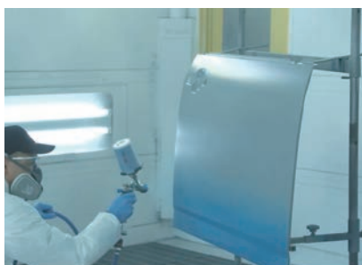
07 ベースコートをパネル下部から1.5コートで塗装
