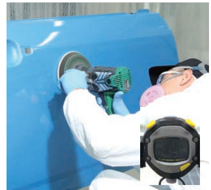
15 ゴミ・ブツ除去後、ウールパフを装着したシングルポリッシャーで磨いた後、スポンジパフで磨いて完成
