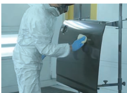
02 金属素地部分にワイプでプライマーを塗布。スプレーガンを使わないので作業性が高い。フラッシュオフタイムは約1分間
