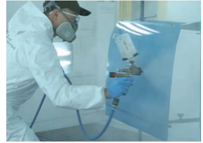
12 2コート目で1.5コート塗り。ガン速度を落とし、ゆっくり肌を整えていく
