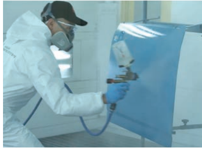
11 タッククロス・アンド・エアブローでホコリを落とし、CC6750をパネル上から塗布。スタートは0.5コートを意識する
