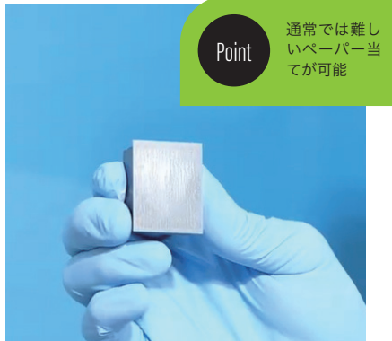
14 作業開始から43分。乾燥終了し、数分間クールダウン後、3000番のペーパーでゴミ・ブツ取りを行う
