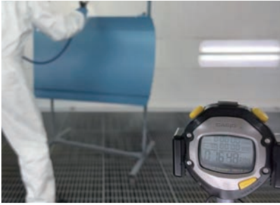
10 パネルから1mほどの距離からエアブローを当てて乾燥させる。湿度にもよるが、今回は約7分ほどで乾燥終了
