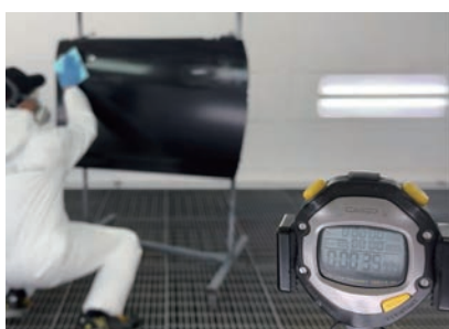
01 ストップウォッチを押し、作業開始。脱脂剤パネルを洗浄する
