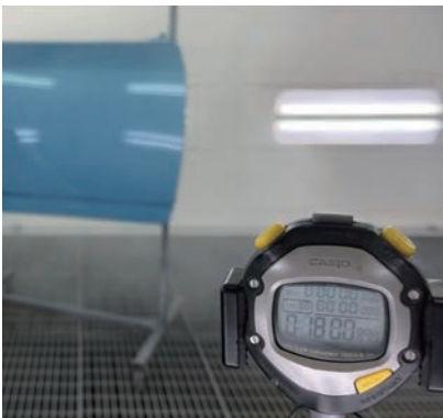
13 作業開始から18分。クリアー塗装終了。45℃×20分で乾燥させる
