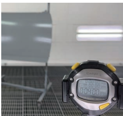
05 作業開始から4分。ノンサンディングサフェーサー塗布終了。5分間乾燥させる
