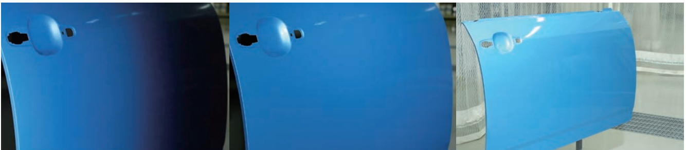
Finish ライトを当てて、磨き戻りやパフ傷をチェックして終了。作業時間は約45分
