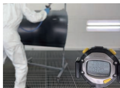
03 作業開始から3分20秒。ノンサンディングサフェーサーを塗布
