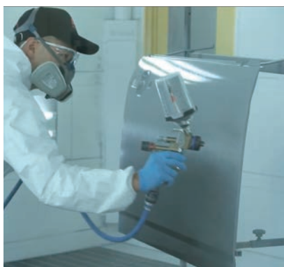
04 スプレーガンでパネルの上から下へ塗布。電着プライマーが隠れる程度に均一に1コート塗装する
