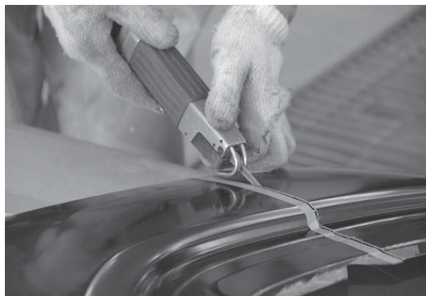
エアソーを使用した切断
