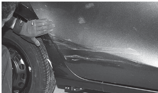
外板の損傷確認
