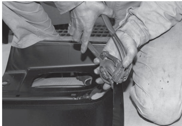
パンチングツールによる穴開け
