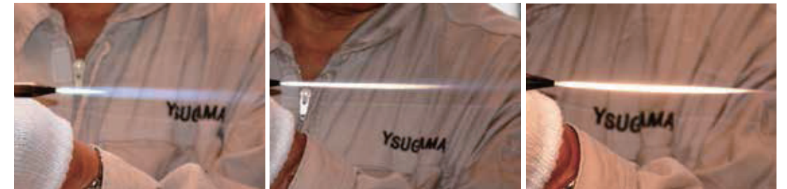
①酸素・アセチレンバーナーは、炭化炎をベースにしてあぶり出しに使用します
