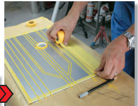
ラインばかりでは単調なので、変化が欲しいところ。左右にリボンパターンを入れよう！ グラフィックをペイントする部分にマスキングテープを貼る
