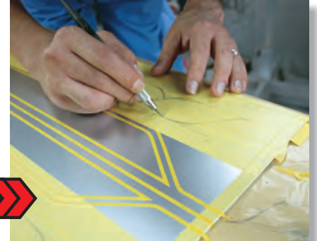
アウトラインに沿ってカット。マスキングテープのみカットするよう、力加減に気を付ける。カッターの刃をこまめに交換することも大切
