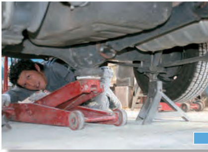
リヤも同様に。リジトラックはサスペンションメンバーなど硬い個所に置く
