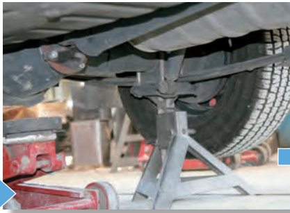
リヤも同様に。リジトラックはサスペンションメンバーなど硬い個所に置く
