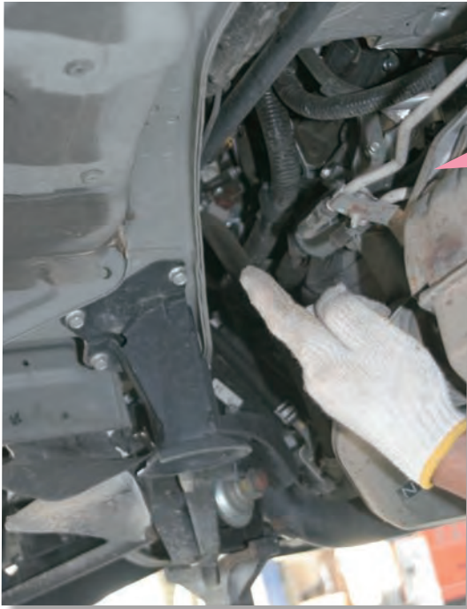
リヤも同様に。リジトラックはサスペンションメンバーなど硬い個所に置く
