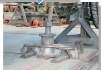
チェーン固定用具をレールに取り付ける。さらにクサビを入れてしっかりと固定する
