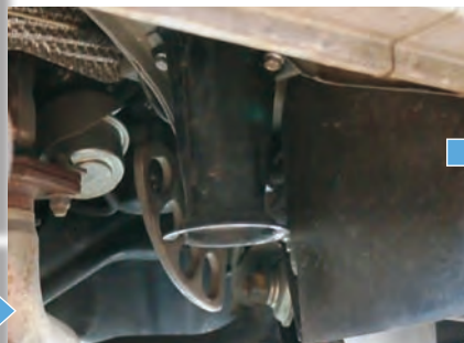
固定個所が狭いため、チェーンで引く角度を変えられるアングルタイプのクランプを使用する
