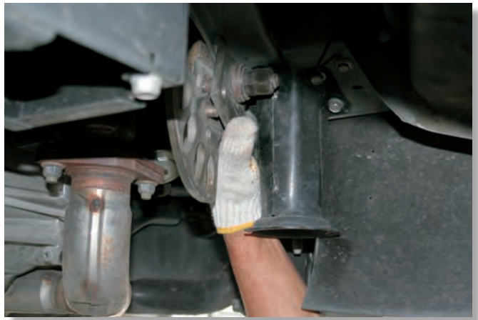
損傷部位にもよるが、チェーンを使って固定する際に障害となるタイヤを外しておく
