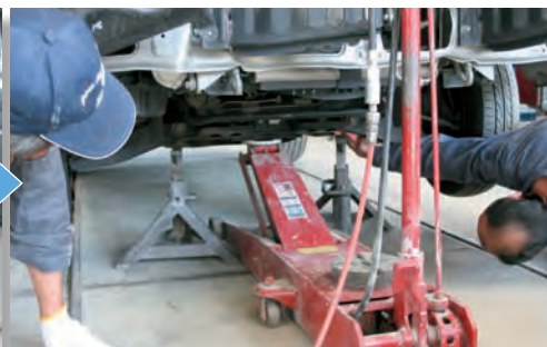
フロント側をガレージジャッキで持ち上げリジトラックで支持する
