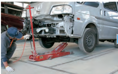
フロント側をガレージジャッキで持ち上げリジトラックで支持する
