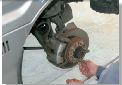
損傷部位にもよるが、チェーンを使って固定する際に障害となるタイヤを外しておく
