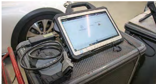
●XENTRY (メーカー車両診断機)
