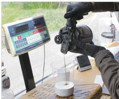
選んだ色見本の配合データをベースに計量。塗料は朝だけではなく、調色前にも必ず攪拌する
