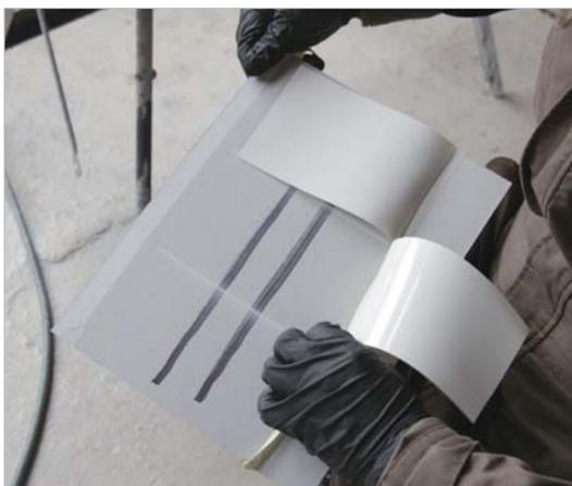
カラーベースの吹き付け準備。テストピースは比色の際、ポデーに貼り付けて確認しやすい透明のシート状のものを使用する。テストピースの下には、黒いラインを引いた台紙を重ね、トマリ具合を確認する
