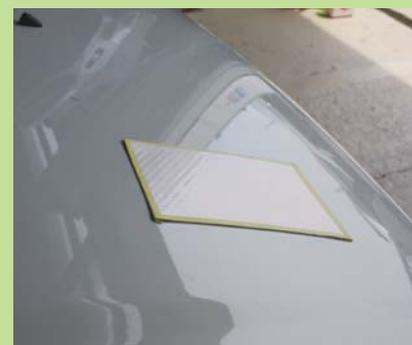
スカシ、正反射の立ち位置を確認するためにオリジナルツールを使用している。スカシでは青く、正面では赤く見えるような塗り板を作製。パネルを見ている角度を確認しやすくしている
