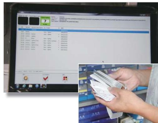
PCの検索画面にメーカー名と塗色コード、塗料ライン、測定結果を入力して分析すると、候補のカラーカードが表示される。バリエーションデッキからカラーカードを選択する
