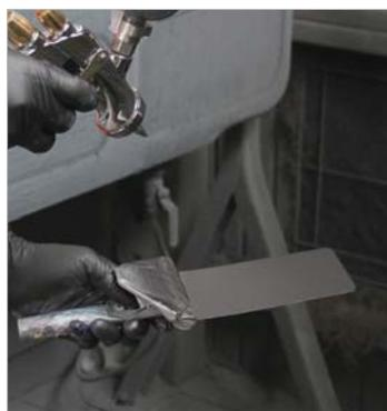
ブリキ製のテストピースに吹き付け、エアブローで乾燥させる
