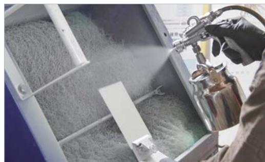
パールベースの吹き付け塗装。塗装回数が2回、3回、4回の3パターンを作る
