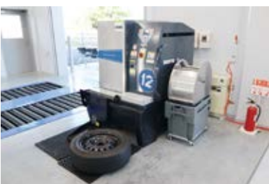
ホイールの洗浄も「ホイールウォッシャー」を使って効率化。ビーズを使い洗浄力をアップさせている
