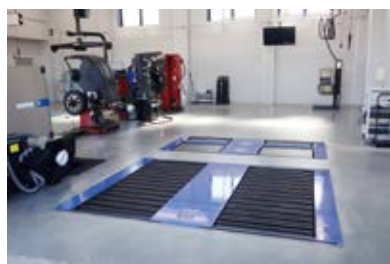
車検システム、サイドスリップテスター、車両撮影システム、ヘッドライトテスターで検査ラインを再現
