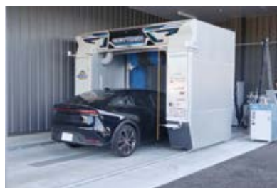
門型洗車機の「アクール」。ナノバブル発生装置の他、超純水発生装置、下部洗浄装置も備え、洗浄力は抜群
