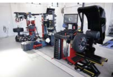
全自動タイヤチェンジャー2種の他、ホイール balancer「ロードフォースエリート」も完備
