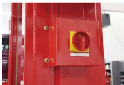
門型リフトは操作レバー付近に安全スイッチを配置
