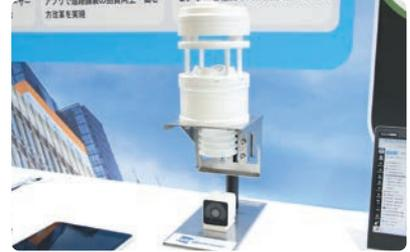
気象庁承認のIoTセンサー「ソラテナPro」は工場へ設置することで気温や天候状況を観測。データは事業者へ提供され、熱中症対策や荒天など気象状況を通知して対応を促す
