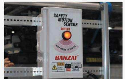
検知時には制御盤のボタンが点灯
