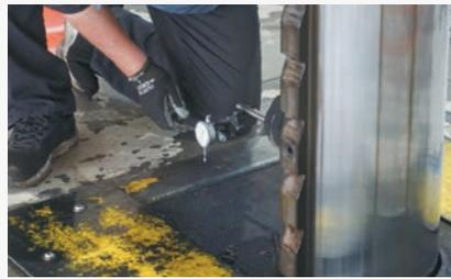
シリンダーにダイヤルゲージを固定。一定時間で自然降下する量を測定
