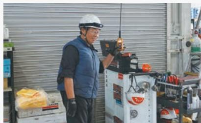
リモコンの動作確認からリモコンケースまでを点検。リモコンケースは割れが生じている場合、短絡の恐れがあることから要注意
