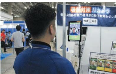
AIカメラによる顔分析で暑熱リスクを作業者に伝える「カオカラ」をデモンストレーション。WBGTの外環境情報から判断し、4段階で作業者にリスクを伝え暑さ対策を促す
