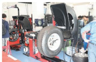
大型車に最適なホイールバランサー。227kgまでのタイヤを正確・簡単に持ち上げることが可能。レーザーを使用した独自のシステムで短時間に多くの情報を取得できる
