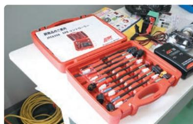
近年増えてきた電子パーキングブレーキの解除は、緊急時の車両移動の際に困難を極める。本製品なら12Vバッテリーに接続することで、タイヤも外さずに解除できる
