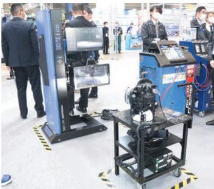
業界初の二輪車すれ違い前照灯（UN R198/112/113）の測定に対応したヘッドライトテスター。手でランプ正対し、カラーCMOSカメラで配光を画像処理。すれ違い灯・走行灯の照射方向と光度を自動で測定・合否判定結果を業界最大のLCD21インチモニターに表示
