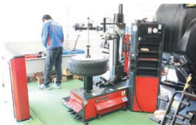
コンパクトさに優れたレバーレスオートマチックタイヤチェンジャー。アッパーアームに装着したローターヘッドが組み付けまでの一連の工程をサポートする
