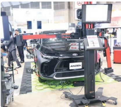
故障診断からホイールアライメント計測・調整、エイミングまで1台で完結できる「MaxiSys ADAS IA900WA」。設置工事が不要な可搬式で、作業を行わない時はストール外へ移動可能。ハイエンドモデルのスキヤンツール「MaxiSys Ultra」も付属するなどコストパフォーマンスが高い
