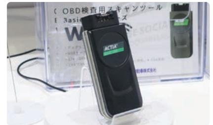
自動車用診断ツールを世界で初めてリリースしたACTIA社製のOBD検査用スキャンツール「ACTIA Basic One」。Wi-FiモデルとUSBモデル(近日発売予定)の2タイプでDoIPにも対応予定
