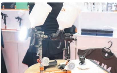
Walcomの新タイプのスプレーガン「スリムコンパクト」。マグネシウムポデーに、防刃ベストなどに使われる素材ケブラーをアウトサート（埋め込み）加工。高温に強く、有機溶剤にも溶けない
