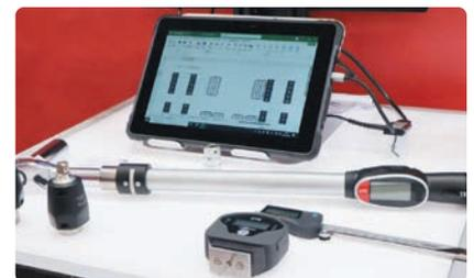
測定データを自動で送信・入力が行えるデジタルトルクレンチ「メモルク」と、Excelに追加するだけで測定データを管理できるアプリをセットした「KTCお手軽DXスターターパック」をPR
