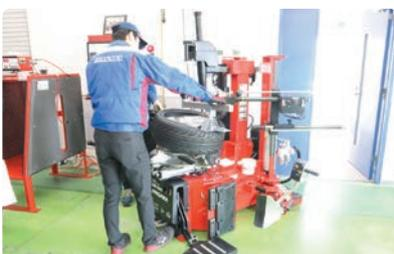
デュアルツールの搭載でレバーレス操作を可能にしたNSシリーズのフルスペックモデル。困難なタイヤはレバーレス、一般的なタイヤはレバー操作と使い分けが可能
