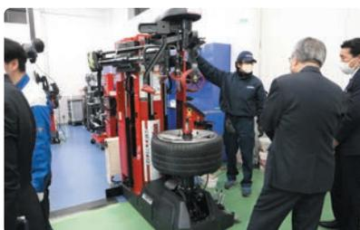
誰でも簡単にタイヤ交換が可能でありながら、安全性と作業品質を確保したハイグレードモデルのフルオートマチックタイヤチェンジャー。作業時間の大幅な短縮が可能
