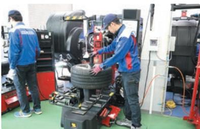
高性能自動機能で多種多様のタイヤ交換作業を快適にこなせるタイヤチェンジャー。LCDタッチスクリーンで、タイヤのサイズに合わせてきめ細かな設定が可能
