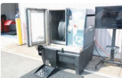
化学薬品を必要としない、温水と専用ビーズで、環境にやさしく時間効率の高い方法でタイヤを洗浄できる。大型タイヤ・ホイールのリフトアップも付属リフトで簡単
