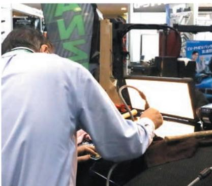
IHの強力加熱で鋼板を膨張させて補修する画期的なデントリペアシステム「T-Hotbox」。100Vの電源につなぐだけでセッティングでき、コンパクトで持ち運びも便利のため、出張作業にも最適。超高張力鋼板にも対応し、塗膜をはがさずに絞れ、短時間で粗出しが可能
