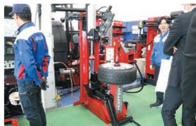
強いパワーと正確性でより簡単に交換できるタイヤチェンジャー。ツールヘッドとベースはホイールサイズに合わせて自動調整。サイズ情報を維持し、再設定の手間を効率化
