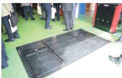
車両を通過させるだけでホイールアライメントを瞬時に測定するQCD（Quick Check Drive）とタイヤの異常摩耗と溝の深さを瞬時に測定するQTE（Quick Tread Edge）
