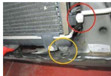
高圧パイプが千切れていた
