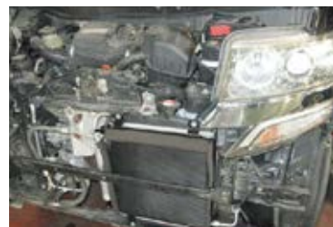
左ヘッドライトとエンジンルーム内の部品を多数取り外し
