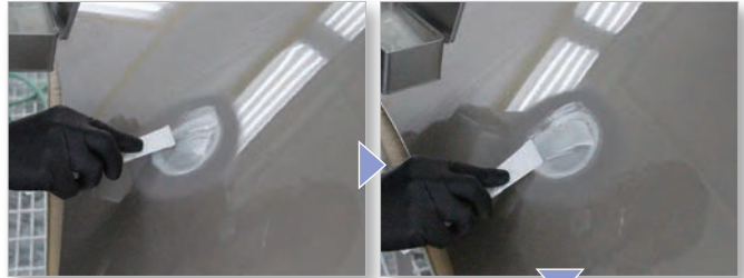
フェザーエッジ左上からUV硬化型パテをゆっくり薄く塗っていく
