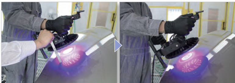
パネルから 10cm ほど離して 1 分間以上 UV 照射機でパテを固める
