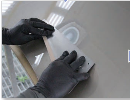
スケールの代わりにノコギリの背を利用して余分なパテを落とすと同時に傷の奥にまでしっかり入れる
