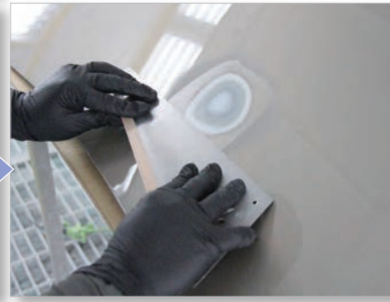
スケールの代わりにノコギリの背を利用して余分なパテを落とすと同時に傷の奥にまでしっかり入れる
