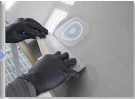
スケールの代わりにノコギリの背を利用して余分なパテを落とすと同時に傷の奥にまでしっかり入れる
