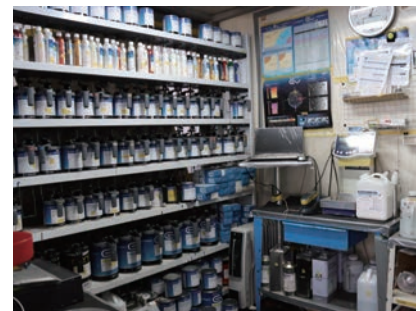
調色室。コンピューター調色システムの活用で、調色作業を効率化している
