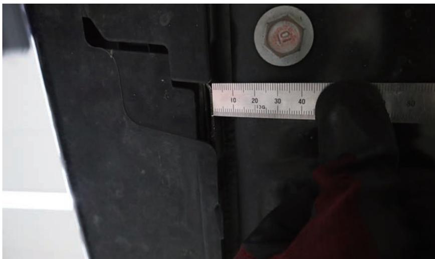
EVではボデー構造の設計段階から、あらかじめ駆動用バッテリー搭載部との間に空間を設定し、事故などでボデーに衝撃が加わった際にその減少幅を計測することで同バッテリーの交換目安とするカーメーカーもある
