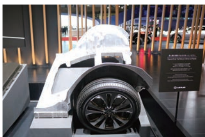
レクサスLF-ZCに採用されたアルミギガキャスト。しなやかさと剛性を両立している
