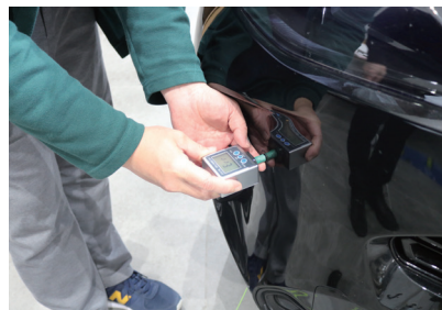
図3 超音波センサー(ソナーセンサー)の角度測定
