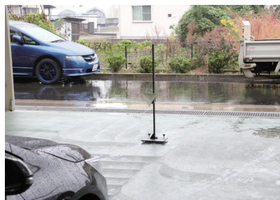
図2 ミリ波レーダー調整作業
