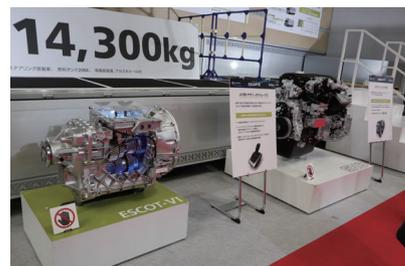
12段電子制御式オートマチックトランスミッション「ESCOT-VI」、ダウンサイジングによる軽量・コンパクト化で積載量拡大に貢献する8ℓエンジン「GH8」を展示
