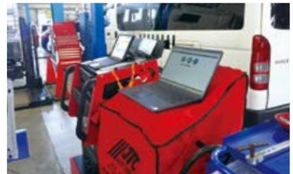
OBD検査の結果は不適合。すぐさま「DST-010」のGTS+でヘルスチェック。すぐ整備用ソフトに切り替えられる点も「DST-010」の強み
