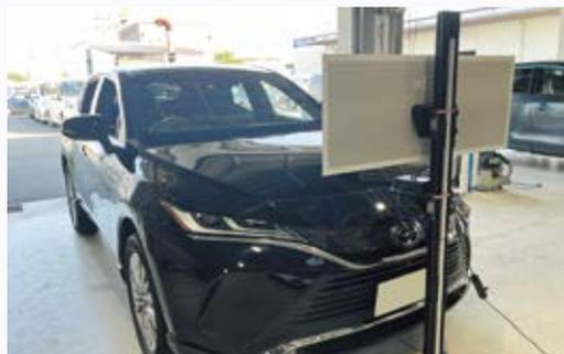
ツールの導入によって、ターゲットを5~10分で設置が可能に
