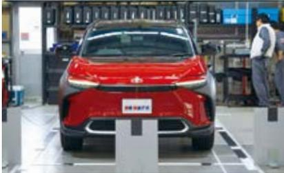
電子制御装置点検整備作業場。なかなか完了しないエイミングが同社に持ち込まれるケースも少なくなく、エイミングの聖地とも呼ばれる。画像はb24Xのパノラミックビューモニター画面調整
