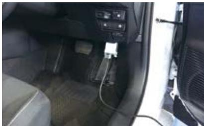
膨大に保有する検査用スキャンツールの中からデッソン「DST-010」をチョイスし、接続
