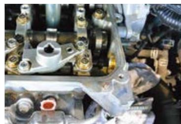
[写真4] インジェクター、吸排気のカムシャフトが見える
