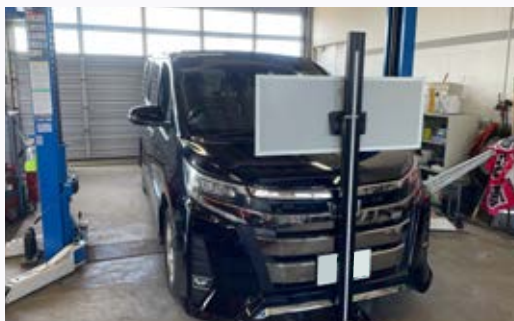
飛び石によるガラス交換時のカメラ調整でツールが大活躍
