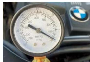
負圧を作ろうにも微動だにせず＝正圧状態
