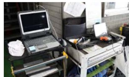
検査ラインには、専用と兼用1台ずつの検査用スキャンツールを常設
