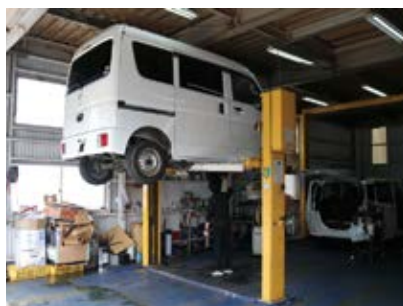
2柱リフトを2基設備し、車検・整備に当たる
