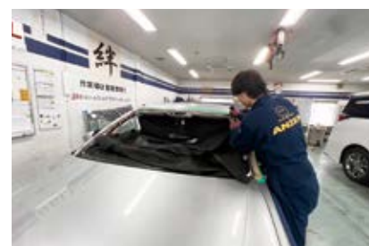
フロントガラス交換作業
