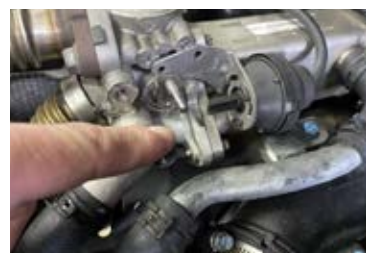
破損部品はEGRクーラーと一体のため同時交換
