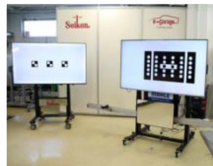
ADASトレーニングの実習に使用する、「MAHLE TechPRO Digital ADAS」と「Seikenエイミングモニター」
