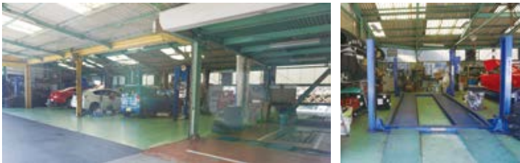
検査ライン（手前）を含め、全5스토ールの整備作業場とドライブオンの4柱リフト
