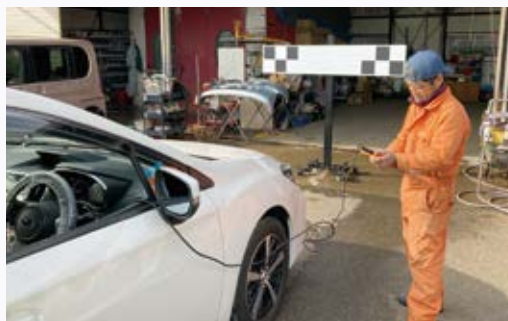
可搬性に優れるため、ガラス交換時の出張作業にも有効
