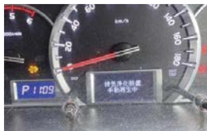
③ インフォメーションも「排気浄化装置 手動再生中」
