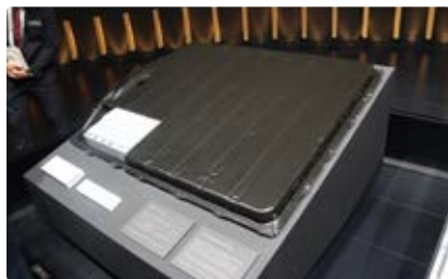
レクサスブースでの次世代バッテリーEV向けの電池パフォーマンス版。バッテリーの高さを低くしエネルギー密度を高めることで、出力を維持する
