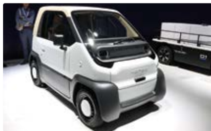
ホンダのコンセプトカー「CI-MEV」。カメラからの画像情報のみで自動走行を可能とする独自技術を採用している
