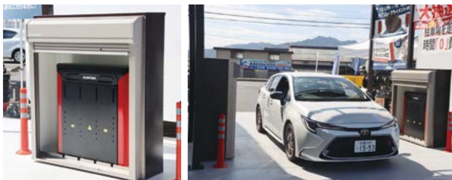
今回導入したクイックチェックドライブ。車両を通過させるだけでアライメントのチェックが完了
