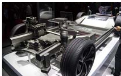
BYDジャパンで展示されたEV専用のプラットフォームe-Platform 3.0。ブレードバッテリーとバッテリーパックをボデー構造に設計段階から組み込む
