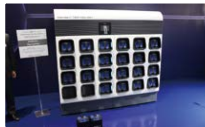
ホンダのバッテリー交換ステーションであるHonda Power Pack Exchanger e.。電動2輪車をはじめとしたEVモビリティのバッテリー交換が可能
