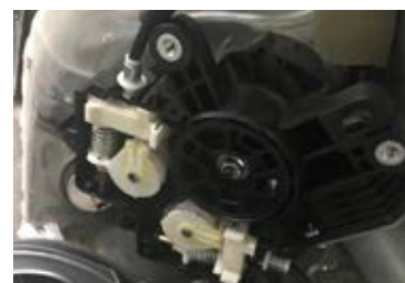
ワイヤ切れもなくモーター正常作動
