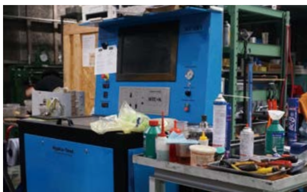
国内で唯一同社が設備するイギリス製のバルブボデーテスター
