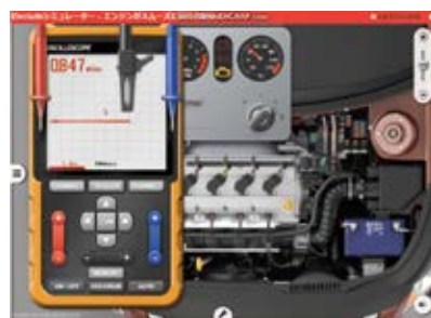
eラーニングシステム・エレクトュードの操作画面。テスターを用いた診断などの疑似体験も可能で、各種作業の流れを安全に確認することができる
