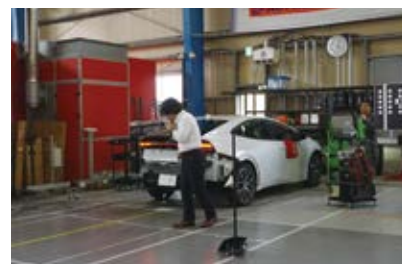
ブラインドスポットモニターセンサーのレーダー反射強度確認を実演する車検・鈑金デポの上松禎知社長
