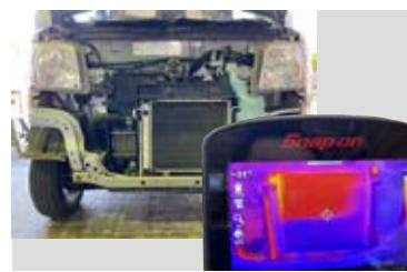
クーラーコンデンサの下半分がサーモグラフィ上では青い(冷たい)
