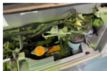
ハイゼット系のエアコン不調の原因はリキッドチューブ
