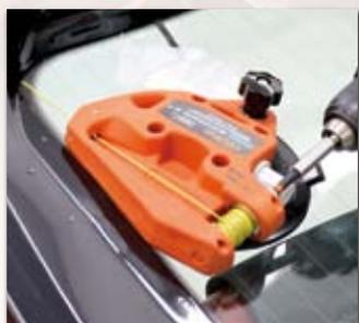
ファイバーラインを電動ドリルドライバー(別売)で巻き上げ、カットしていくためワイヤーに比べ格段に安全。
