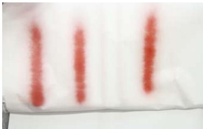
スプレーガンの設定調整や、塗装面との距離によってもパターンは変化する。ガンの性能に加え自分なりのセッティングも重要
