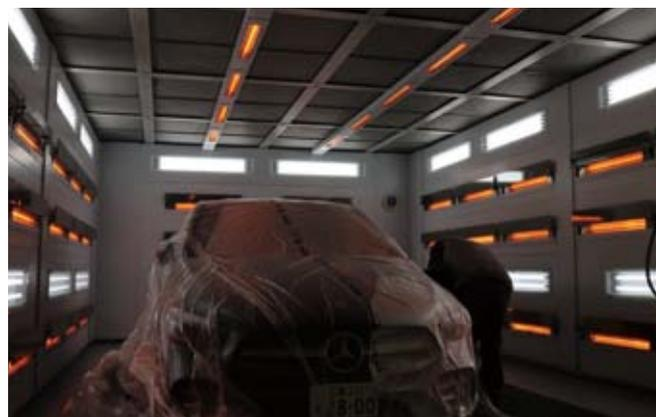
後付けの乾燥システムは既存のブースに設置できる乾燥装置
