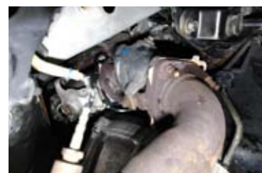
新品のエルボを装着後に 再度PM強制再生
