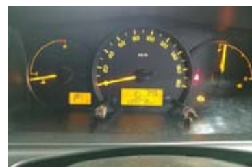
PM強制再生終了後 チェックランプが点灯
