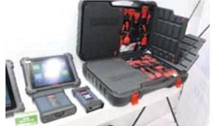
EVやHVの駆動用バッテリーの検査・診断に対応するスキャンツールを参考出品。VCI、スキャンツール、バッテリー接続用の各種コネクタ及び端末のセットで、バッテリーの各種データの確認が可能
