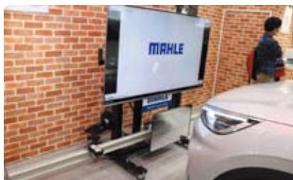
カメラ調整用ターゲットをモニターに表示し、キャリブレーションに対応する「MAHLE TechPRO Digital ADAS」を展示。車両との位置関係から、ターゲットの表示を自動補正することが可能
